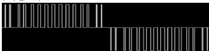
图 3-6 同步调制 15 分频的线电压波形
